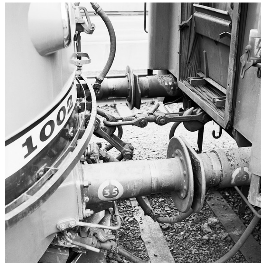
Statens Järnvägar, SJ Rb1 1002. Koppling mellan lok och vagn, Järnvägmuseet, Public Domain
